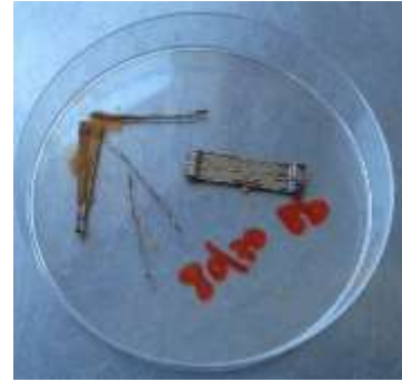
Fibre corrodibili, prova non superata
