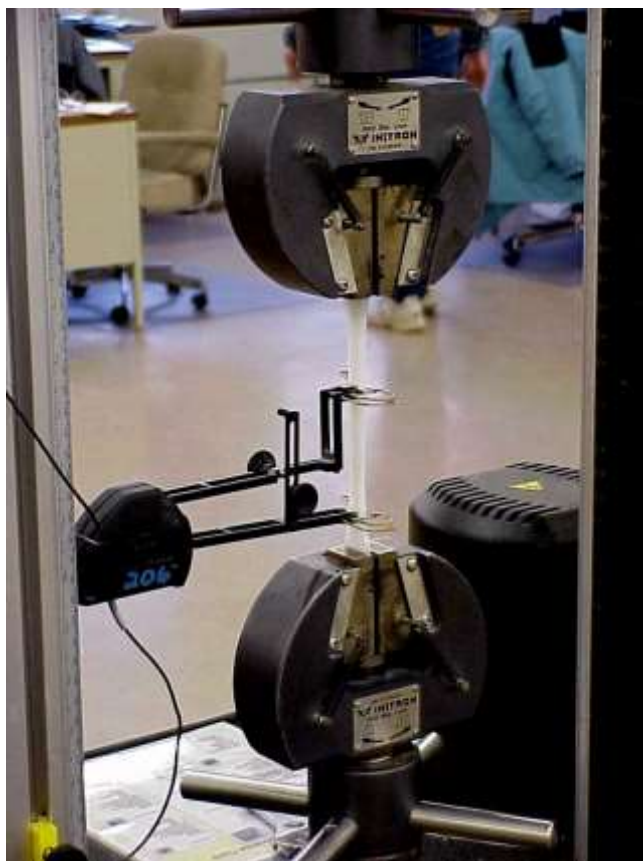
Esecuzione del test secondo ASTM D638
