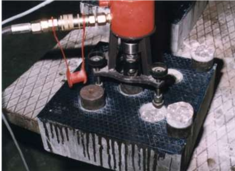
Esecuzione del test secondo UNI EN 1542
