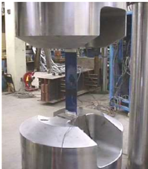
Esecuzione del test secondo ASTM D3039
